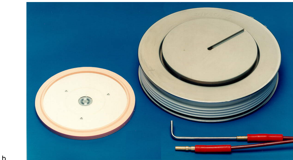
Bild 2.33 Lichtgezündete Thyristoren (LTT) a. Schnittbild b. Thyristor und Halbleiterscheibe (Wafer)
