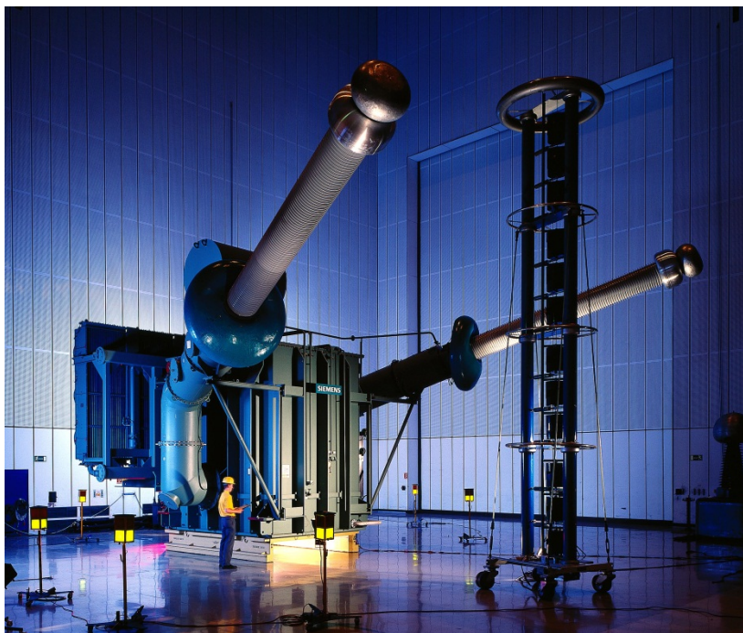
Bild 2.36 270-mH-Glättungsdrossel bei der Abnahmeprüfung beim Hersteller, seitlich Mehrfachabschneidefunkenstrecke zur Erzeugung abgeschnittener Blitzstöße
