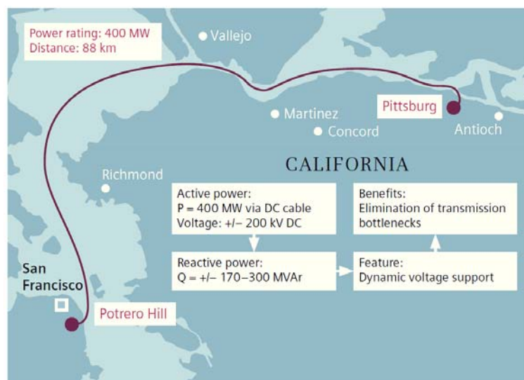
Bild 2.56 Erste von Siemens realisierte HGÜ-Verbindung auf der Basis der Modularen Multi-Level-Stromrichter: Trans Bay Cable
